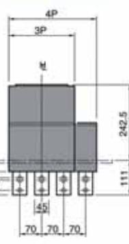
Foratura per il fissaggio (vista anteriore)
